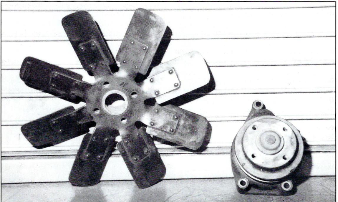
Palas del ventilador y bomba de agua
