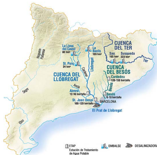
Imatge 15: Esquema del sistema d'abastament de l'ÀMB
