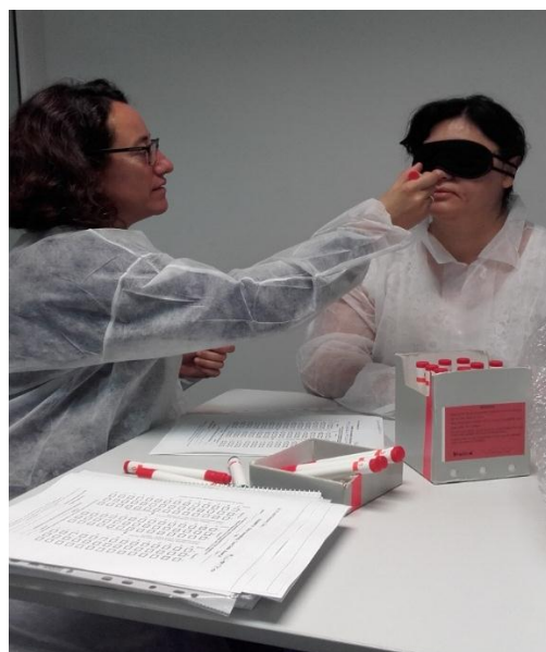
Fotografía 5.2.6: Cualificación de un panelista con los “Snifing sticks” de n-butanol de Burghart Messtechnik GMB
