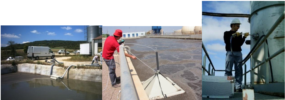
Figura 1.1. Métodos de toma de muestras con Cámara de flujo, Campana y Sonda
