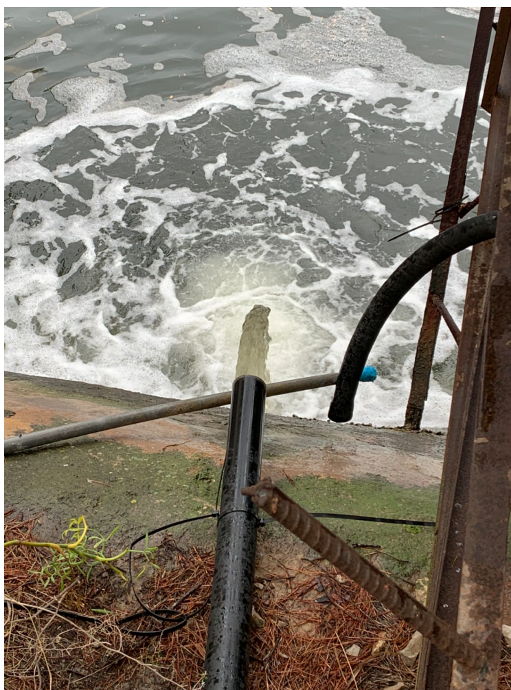
Figura 8.73. Surgència de la Falconera. Mostreig de la crescuda del 5 de desembre de 2019 al pou Eusebi (cabal: 3 L/s). El color groc fosc de l'aigua a "boca de pou" (bassa pedrera) és per la influència dels lixiviats (Fotografia AMB).
