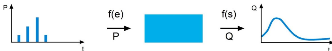
Figura 2.1. Enfocament sistèmic: la funció d'entrada a l'aqüífer la defineixen les precipitacions i la funció de sortida el cabal.
