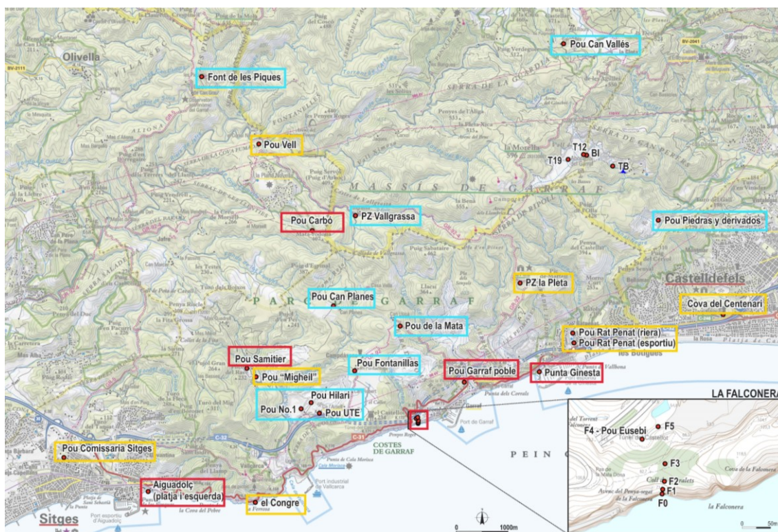
Figura 8.35. Punts de mostreig amb un codi de colors en funció de si s'ha observat o no influència de lixiviat. Blau: no s'ha detectat cap paràmetre que indiqui influència. Groc: S'ha detectat algun paràmetre que indica la influència. Vermell: diversos paràmetres independents confirmen la influència dels lixiviat.
