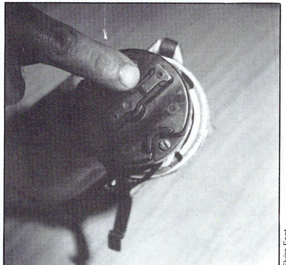
Dedo del distribuidor de corriente
