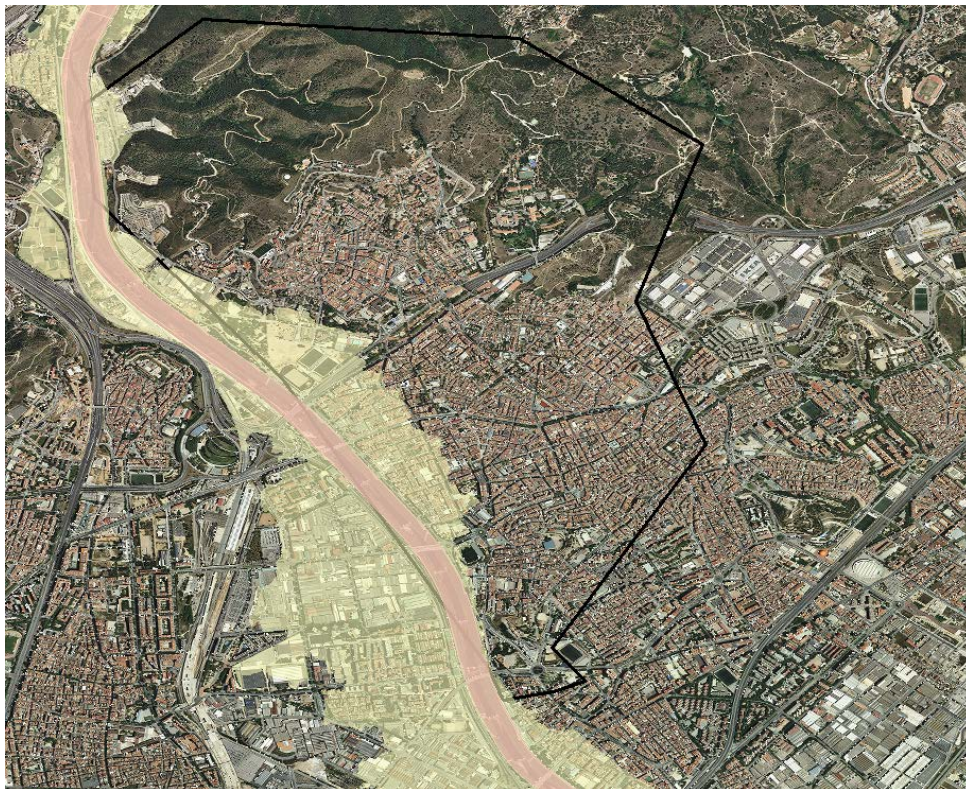
Figura 15. Detall de les zones inundables Santa Coloma amb els períodes de retorn de 500 i 10 anys (segueix la mateixa llegenda que la fig.9) sobre una ortofoto WMS (Capa online del ICC).
