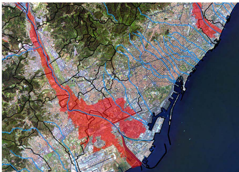
Figura 55. Zona inundable (model elaborat per l'ACA) per un període de retorn de 500 anys al Llobregat i al Besòs. Sobre una imatge en satèl·lit (WMS) i la cartografia de municipis i rius.
