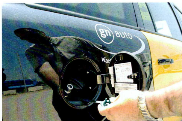
La toma del depósito tiene dos entradas: una para la gasolina y otra para el gas.
