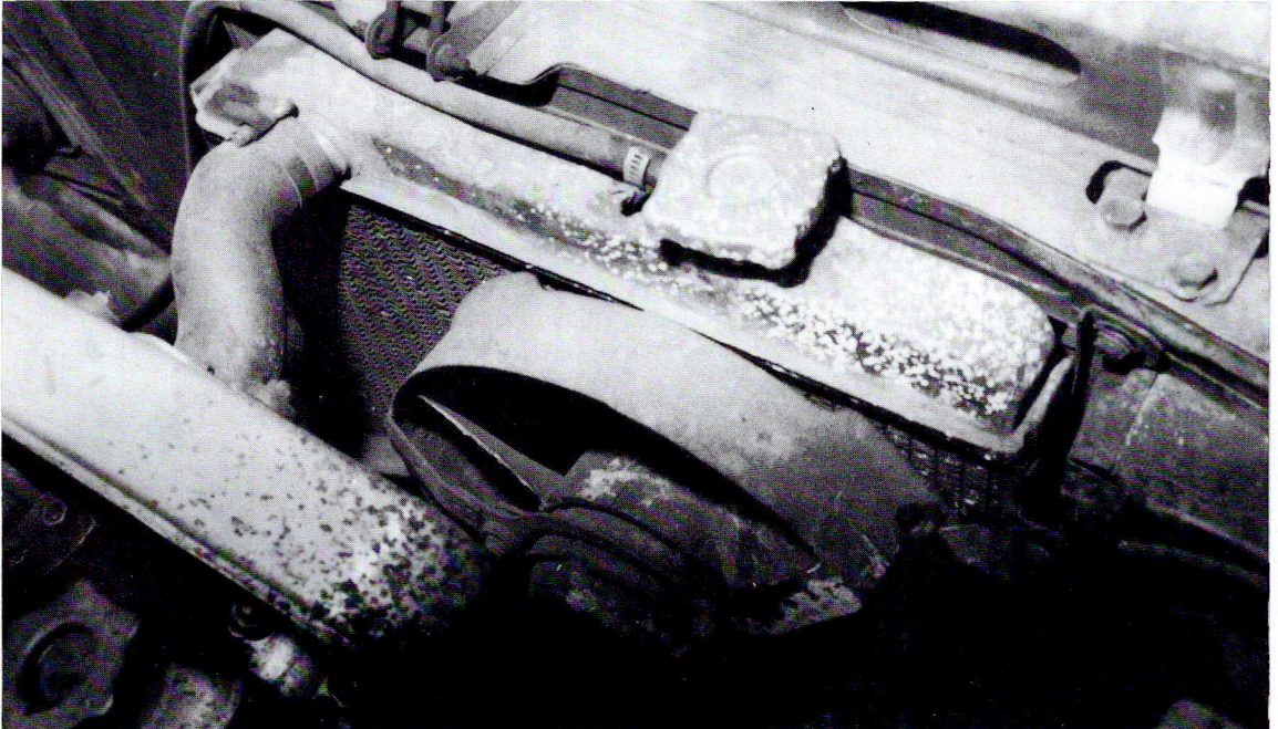
Radiador de agua del circuito refrigerante del motor con su electroventilador
