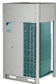
Bomba de calor VRV, P_{ref} = 61,5 \text{ kW} , EER = 3,77 y SEER = 7,07
