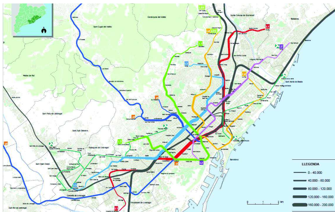
Figura 34. Gràfic de càrregues de demanda diària per trams a la xarxa de metro (2006)
