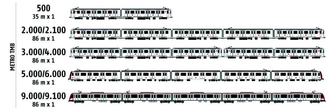
Figura 32. Identificació del material mòbil del Ferrocarril Metropolità de Barcelona
