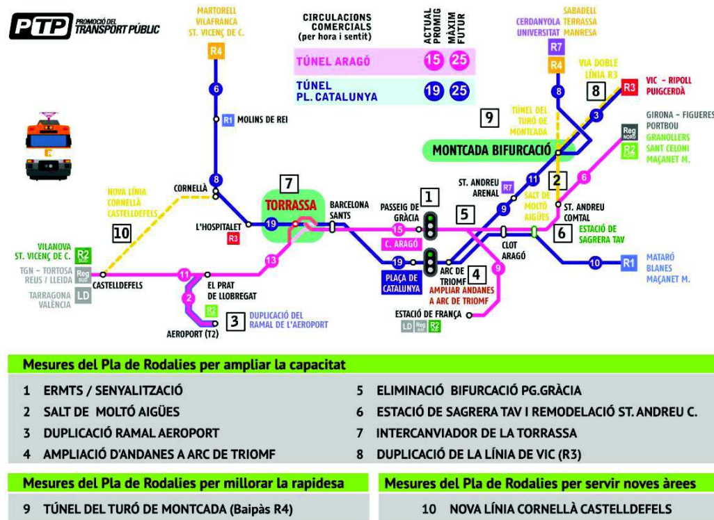
Figura 59. Mesures que incrementen la capacitat previstes al Pla de Rodalies 2007-2015 i al Pla Director d'infraestructures 2011-2020
