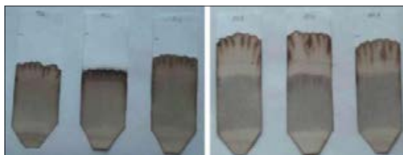
Figura 9. Cromatogrames obtinguts amb agitació contínua circular (esquerra) i contínua orbital (dreta)
