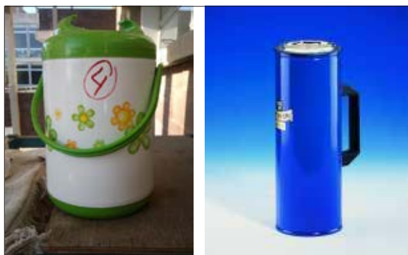
Figura 13. Carmanyola aïllada tèrmicament al laboratori (esquerra) i vas Dewar (dreta)
