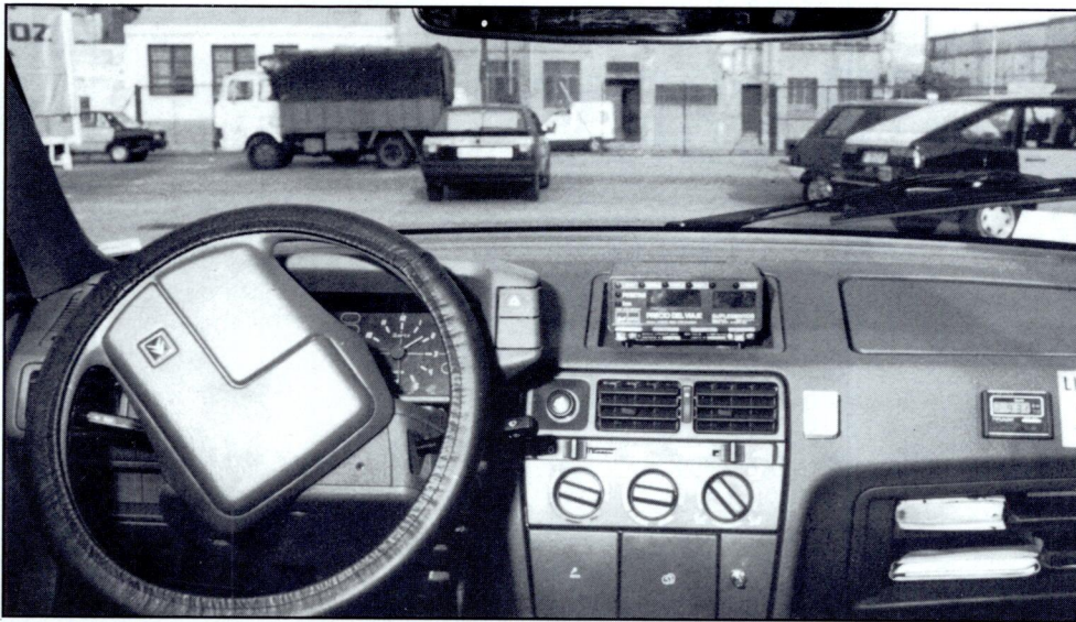
El modelo Citroën BX sale de fábrica preparado para poder trabajar como taxi, su tablier está diseñado para situar correctamente el taxímetro.
