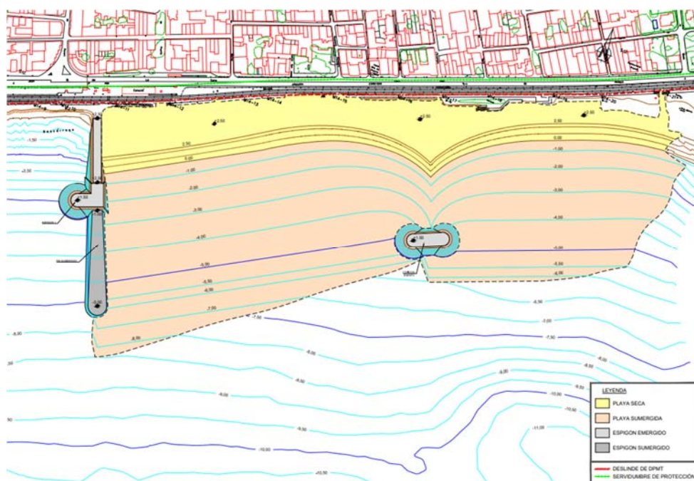
Figura 26. Imatge d'un dels dics en L projectats (font: MARCIGLOB, 2018).
