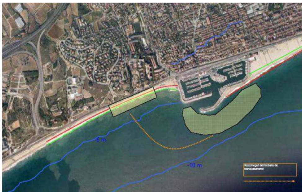
Figura 17. Zones d'actuació als voltants del port del Masnou, amb dragatge al dic exterior i abocament a la platja del Masnou (font: SENER, 2010).
