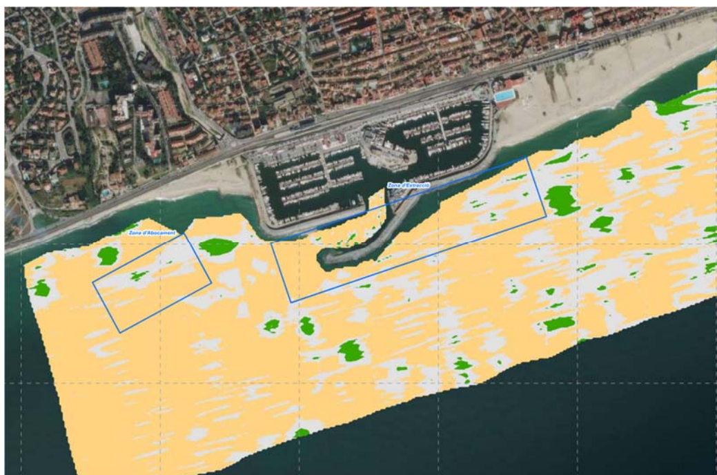
Figura 31. Zona d'extracció i abocament (font Tecnoambiente, 2020). Es pot veure que la zona d'abocament està situada en una platja ja totalment erosionada i sense condicions de contorn a ponent del port.
