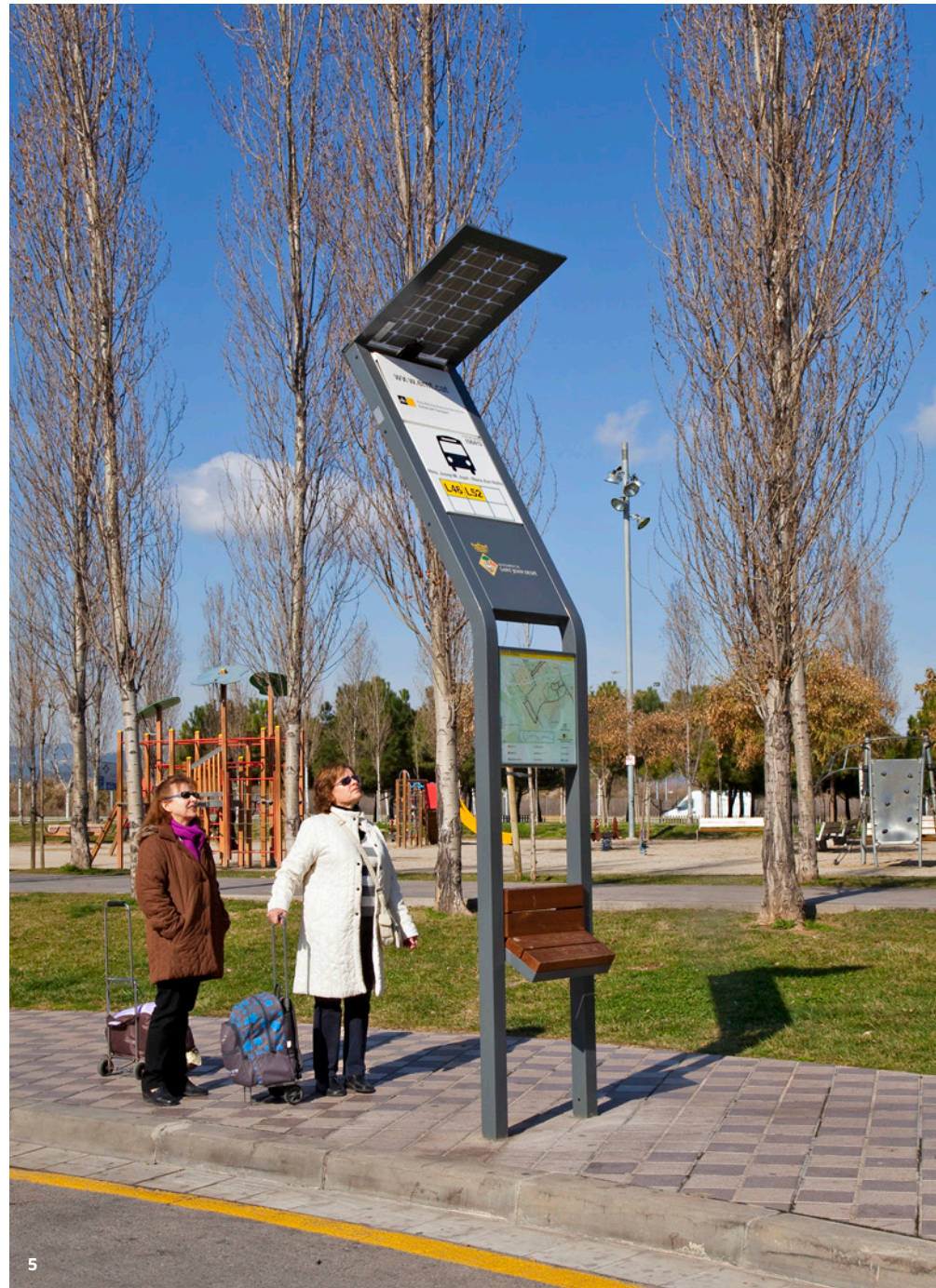
5. S'han instal·lat 100 parades solars amb pantalles digitals per millorar la informació a l'usuari.
