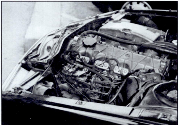
Motor diesel con bomba inyectora
