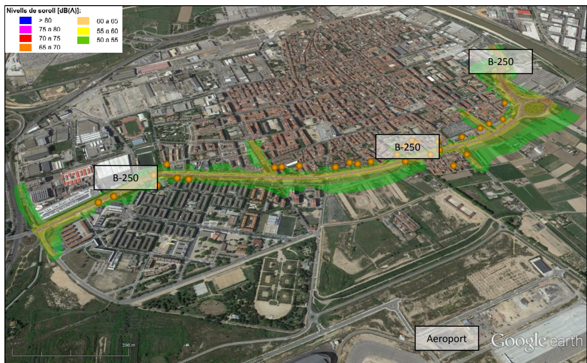
Imatge 10: Resultat de l'avaluació d'edificis de l'àrea de El Prat de Llobregat. Període nit.
